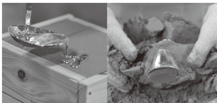
図2 左: 砂型に錫を流し込む様子 右: 砂型に錫を流し込んだのち、型から小型タンブラーを取り出す様子
