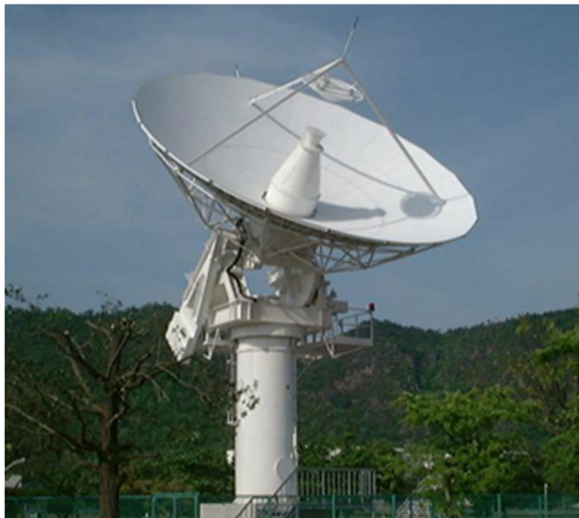
岐阜大学 11m 電波望遠鏡. 星の周りの水蒸気から放射されるレーザー電波（レーザーの電波バージョン）を観測し、その運動の速さや電波の強さの変化などを測定する
